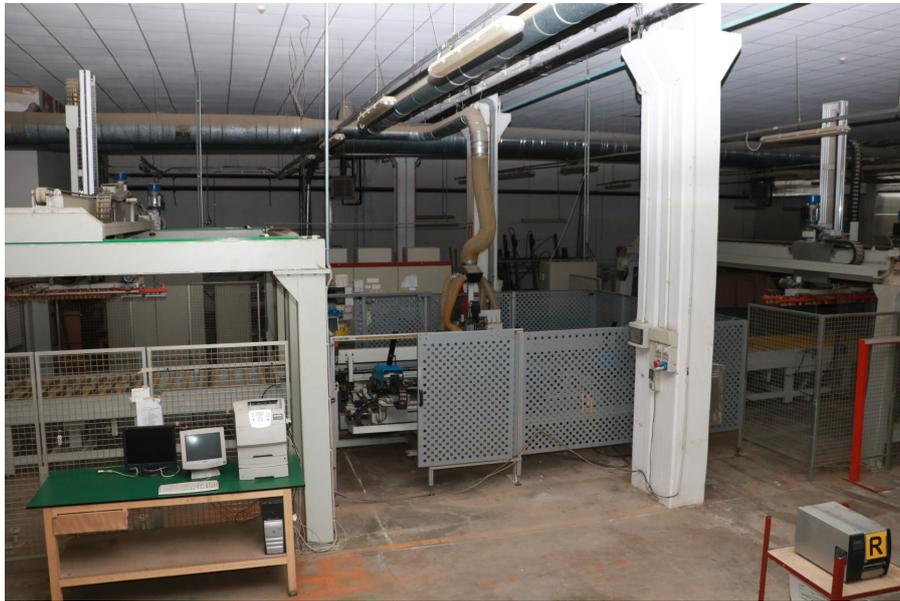
Ligne **PROJECT DOOR** avec les chargements et déchargements automatique ainsi que les transferts entre chaque machine pour le travail en simultané de :
